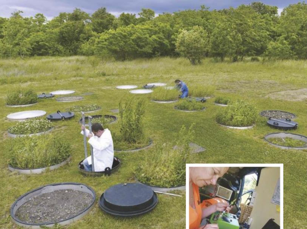
Le Gisfi a installé une plateforme expérimentale à Homécourt (Meurthe-et-Moselle), sur le site d'une ancienne cokerie. Des lysimètres de 2 m 2 instrumentés à 2 m de profondeur servent à étudier la qualité de l'eau.
