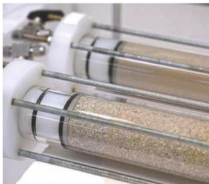
Des essais de dépollution, notamment avec des liquides non newtoniens, sont menés dans des colonnes centimétriques et métriques, avant le pilote.
